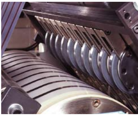
Individuelle Prägeradeinstellung Individual stamping wheel adjustment
